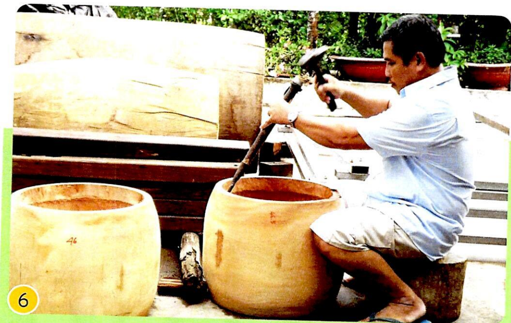
Bước 1: Đục gỗ để làm tang trống
