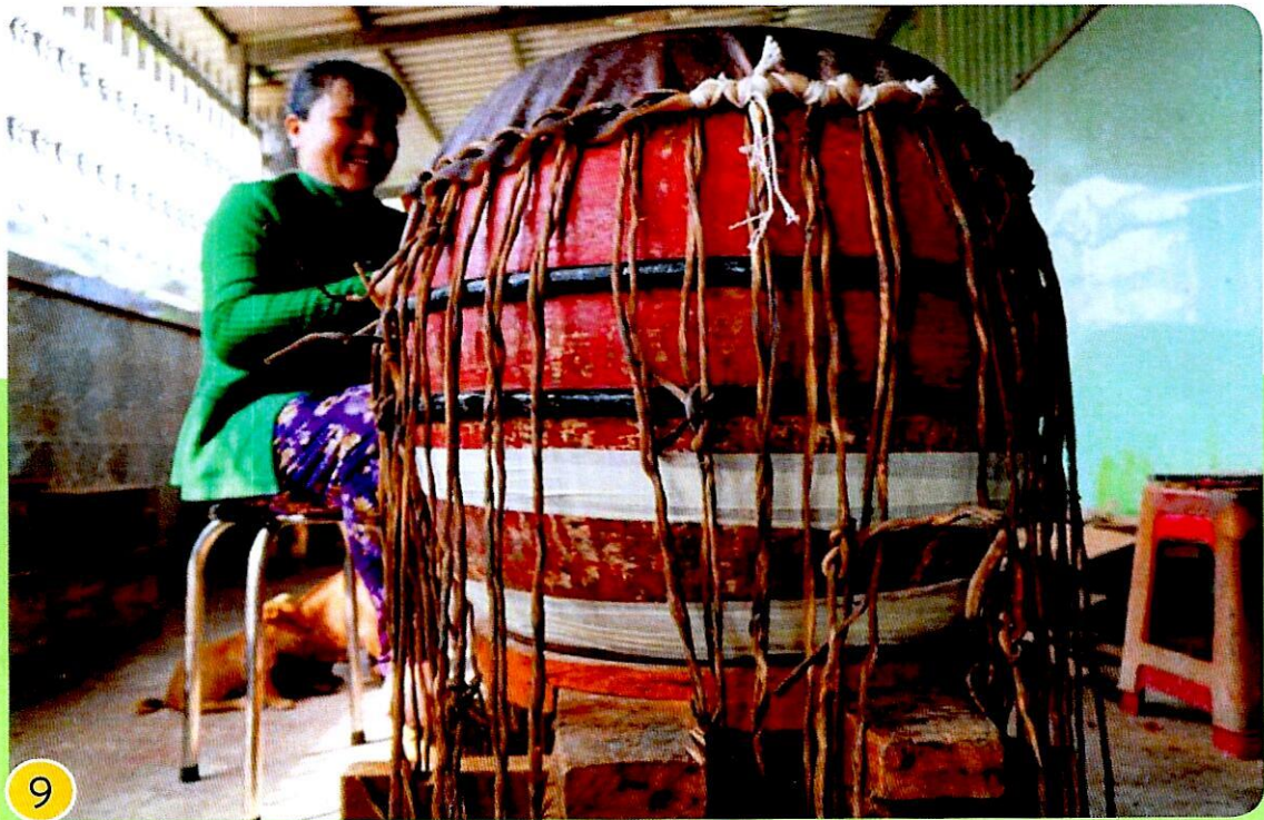
Bước 4: Căng dây, phủ da lên mặt trống
